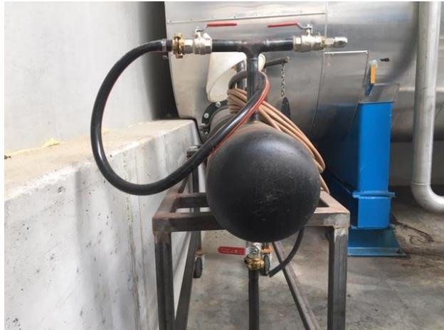
La mise sous vide peut être réalisée en reliant l'autoclave de laboratoire directement à l'installation de traitement et sa pompe à vide qui permet d'atteindre des pressions négatives de plus de 0.85 bar. Dans
