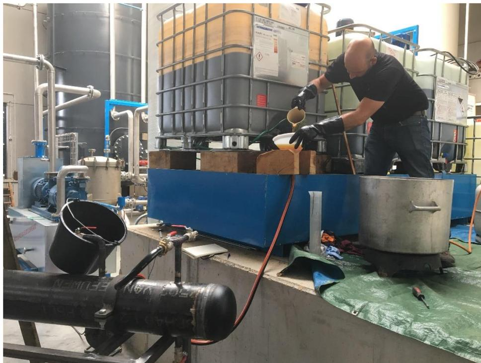
La mise sous pression est réalisée en connectant l'autoclave directement à la pression d'air du compresseur. Habituellement, c'est une pression hydraulique qui est appliquée mais ici, le cycle a été adapté. C'est une pression d'air qui génère la pression pour faire pénétrer l'huile dans le bois. La phase de pression appliquée est de 90 minutes.
