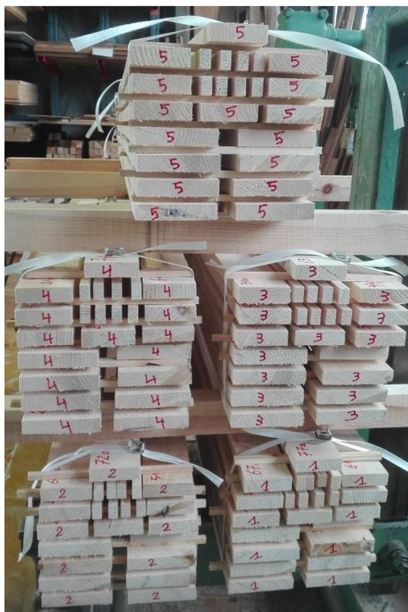
Fin août 2019, les lattes traitées ont été réexpédiées au DEMNA et le façonnage des éprouvettes (50x25x15 mm) a eu lieu selon le schéma ci-dessous.
